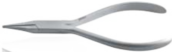
DO.874.300 Schwarz graduated Optical style, round and concave beaks. Loop forming pliers. Graduation prevents wire slippage. Pinza stile ottico per formare le anse con punte tonda/concava. Le tacche prevengono lo scorrimento del filo.
